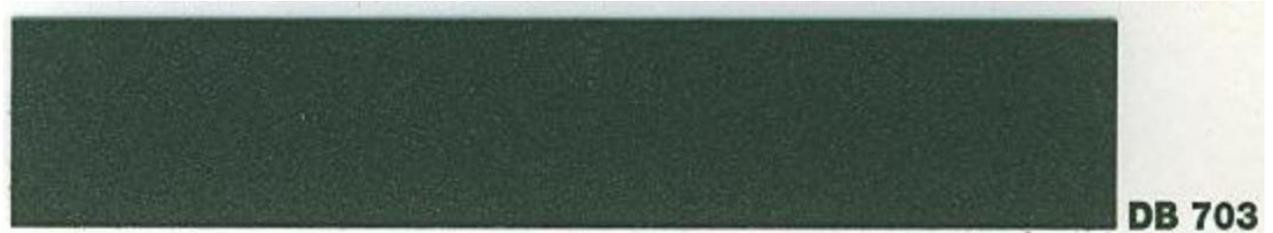
Stahlbauteile: Längsträger, Geländer, Pfeilerköpfe: Dunkelgrau DB 703
