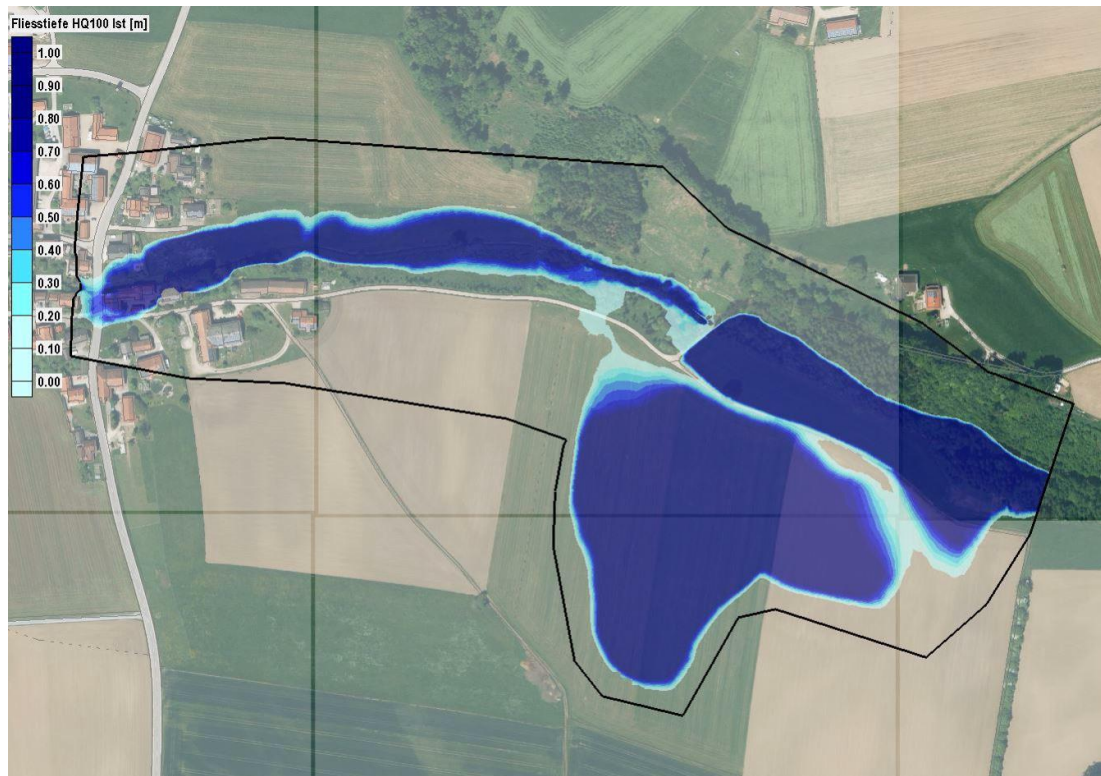
Abbildung 36: Fließtiefen [m] des Anninger Bachs bei einem HQ 100 im Bestand
