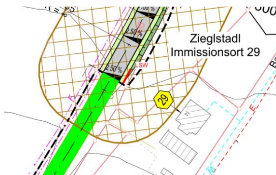
Abbildung 51: Lage der möglichen Lärmschutzwand für Immissionsort 29
